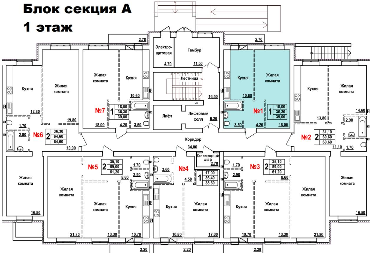
1. В Квартире выполняются: межквартирные перегородки, установка входной двери в квартиру, установка пластиковых окон в квартире, монтаж системы отопления, монтаж труб холодного и горячего водоснабжения, монтаж стояков канализации с установкой тройника для подключения квартирных сантехнических приборов, кабельный ввод в квартиру с установкой вводного щитка с автоматом.
